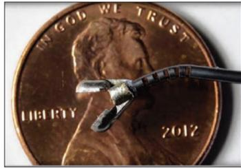
Робот представляет собой руку, сделанную из маленьких трубочек, которые становятся меньше, по мере того как они вытягиваются подобно радиантенне, а на конце - механическое зацепление, толщина которого меньше, чем 1/16-я дюйма, а кроме того, оно может поворачиваться на 90 градусов.
